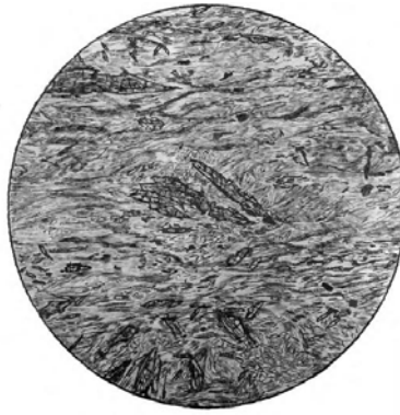
Рис. 11. Тремоліт-талк-хлоритовий сланець. Порфіробластова структура породи обумовлена наявністю порфіробластів тремоліту у вигляді призм без кінцевих граней, які розташовуються діагонально до сланцюватості. Структура порфіробластова з нематолепідобластовою основною масою. Текстура сланцювата або лінзова. Нік II. d=4,1 мм
