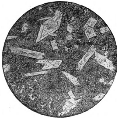
Рис. 2. Хіастолітовий вуглистий сланець . Структура порфіробластова, основна маса мікрогранолепідобластова. Текстура масивна. Нік II. d=7,1 мм
