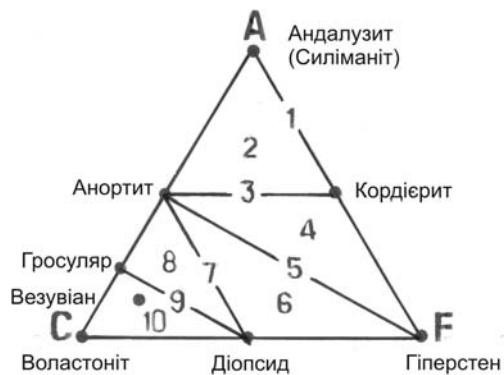
Рис. 4. Парагенетична діаграма В. М. Гольдшмідта (трикутник АСF для порід за умови надлишку \text{SiO}_2 і \text{K}_2\text{O} ): 1–10 – мінеральні парагенезиси: 1–4 – у метapelітах, 5–7 – у metabазитах, 8–10 – у силікатно-карбонатних породах [3]
