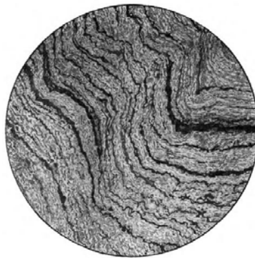
Рис. 8. Зелений сланець складений дрібними зернами альбіту, мікрозернистих мас епідоту, тонких голочок голубувато-зеленого амфіболу, зеленого хлориту – рипідоліту і зерен рудних мінералів. Структура мікронематогранобластова, текстура паралельна, тонкошарувата, пloidчаста. Нік II. d=2,3 мм
