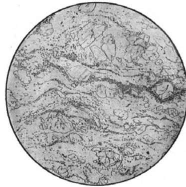
Рис. 32. Мілонізований граніт. Порода складена польовим шпатом, кварцом, біотитом, серицитом і цоїзитом. Структура породи тонкоміліонітова, текстура хвилювасто-сланцювата. Нік II. d=4,1 мм.
