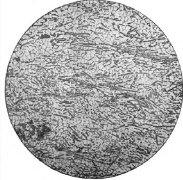
Рис. 12. Кордієрит-антофілітовий кристалічний сланець, складений ізометричними зернами кордієриту і кварцу й тонкими довгопризматичними індивідами антофіліту. Структура нематогранобластова. Текстура породи лінійно-паралельна. Нік II. d=4,1 мм
