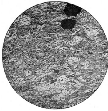
Рис. 13. Епідот-альбіт-амфіболітовий сланець , складений агрегатами зерен епідоту й альбіту, що характеризуються гранобластовою структурою. Ці агрегати перебувають в оточенні волокон амфіболу з фібро-бластовою структурою. Структура фіброгранобластова. Нік II. d=4,1 мм
