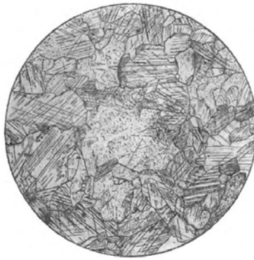
Рис. 23. Мармур . Порода складена ксенобластовими зернами карбонату. Серед домішків трапляються дрібні зерна рудного мінералу. Структура породи гетеробластова, гранобластова. Нік II. d=7,3 мм
