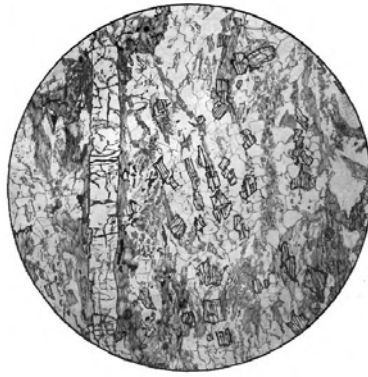
Рис. 17. Біотит-силіманіт-плагіоклазовий гнейс , складений біотитом, силіманітом, кварцом та плагіоклазом. Акцесорний мінерал представлений цирконом. Кварц і плагіоклаз утворюють ділянки гранобластової структури. Структура породи лепідонематогранобластова. Текстура паралельна, масивна. Нік II. d=4,3 мм
