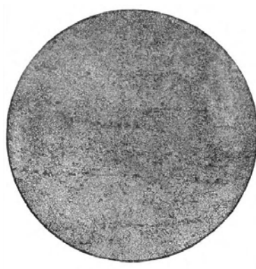
Рис. 5. Біотитовий філіт , складений кварцом, біотитом, хлоритом і рудними мінералами. Структура мікролепідогранобластова, текстура нечітко шарувата. Нік II. d=7,3 мм
