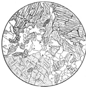
Рис. 24. Кальцифір . Порода складена карбонатом (спайність по ромбодру), діопсидом (різкий рельєф і спайність у верхній частині рисунку), скаполітом, плагіоклазом і калієвим польовим шпатом, які утворюють ізометричні ксенобластові зерна різних розмірів (від 0,1 до 1,0 мм). Серед домішків трапляються дрібні зерна рудного мінералу. Структура породи гетерогранобластова, Нік II. d=2,3 мм
