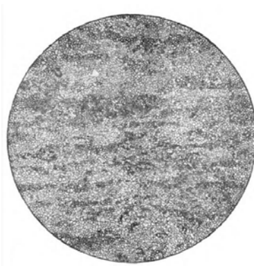
Рис. 3. Піроксен-плагіоклазовий контактний роговик , складений кристалобластовими зернами плагіоклазу, піроксену кварцу і рудного мінералу. Трапляються поодинокі пластинки біотиту. Структура мікрогранобластова, текстура паралельна неправильно-смугаста. Нік II. d=2,3 мм
