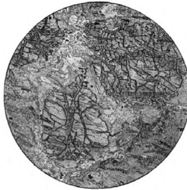
Рис. 22. Епідот-гранат-глаукофанова порода . Структура породи порфіробластова, структура основної маси тонкопаралельно-фібробластова. Нік II. d=6,3 мм
